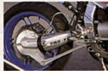
BMW desarrolló el Telelever pensando en motos pesadas y la verdad es que en esa aplicación es imbatible, consiguiendo que esta moto se defendiera notablemente en Calafat: horquilla «guiada» por basculante delante y basculante Paralever sin bieletas detrás.
