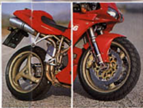
La Ducati es un perfecto ejemplo de suspensiones «tradicionales» de funcionamiento óptimo gracias a esa horquilla Showa de barras invertidas y al basculante monobrazo con amortiguador y bieletas.
