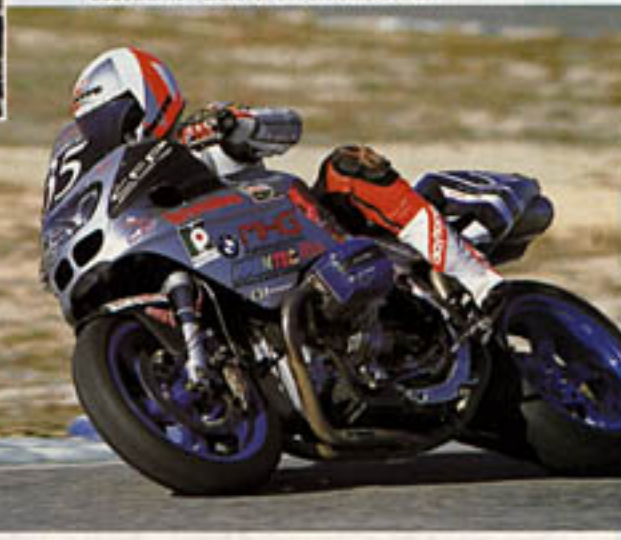
BMW desarrolló el Telelever pensando en motos pesadas y la verdad es que en esa aplicación es imbatible, consiguiendo que esta moto se defendiera notablemente en Calafat: horquilla «guiada» por basculante delante y basculante Paralever sin bieletas detrás.
