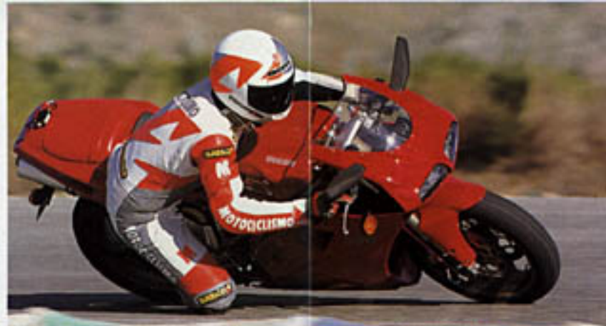
La Ducati es un perfecto ejemplo de suspensiones «tradicionales» de funcionamiento óptimo gracias a esa horquilla Showa de barras invertidas y al basculante monobrazo con amortiguador y bieletas.
